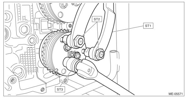
4) Remove the exhaust cam sprocket LH.
